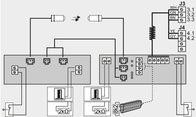
10. STOPP-Kreis / STOP circuit / Circuit d'ARRÊT / STOP-circuit / Circuito de PARADA / Obwód zatrzymania /
