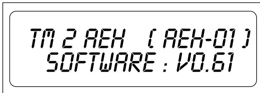
Danach schaltet das Display automatisch in den oben gezeigten Grundmodus. Mit den Programmierknöpfen P1 und P2 wird der Torantrieb programmiert. Mit dem Programmierknopf P1 wird die gewünschte Menuposition gewählt, mit dem Programmierknopf P2 wird der gewünschte Wert, innerhalb der gewählten Menuposition, eingestellt.
